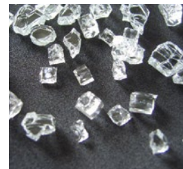
強化ガラスの破損
