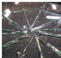
フロートガラスの破損
