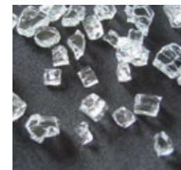
強化ガラスの破損
